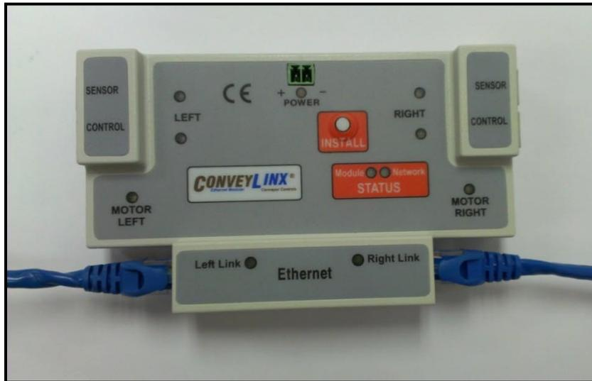
FIGURE 8 - ERSC WITH LEFT & RIGHT ETHERNET CABLES
