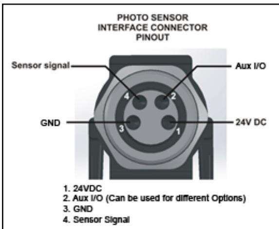
FIGURE 4—MOTIONLINX-AI SENSOR PORT DIAGRAM
