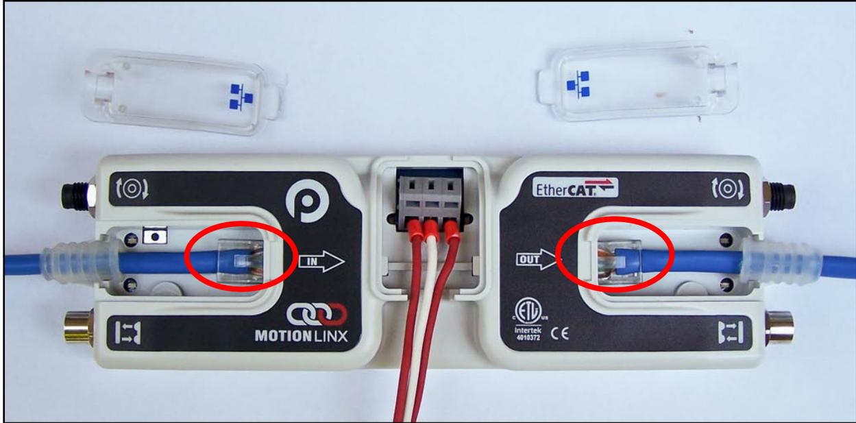
FIGURE 6 – MOTIONLINX-AI WITH LEFT & RIGHT ETHERNET CABLES (COVERS REMOVED)
