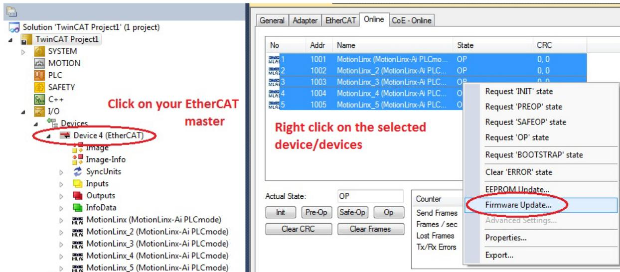
FIGURE 19 - FIRMWARE UPGRADE EXAMPLE
