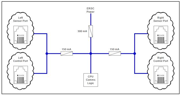
FIGURE 7 - ERSC CONTROL POWER FUSING
