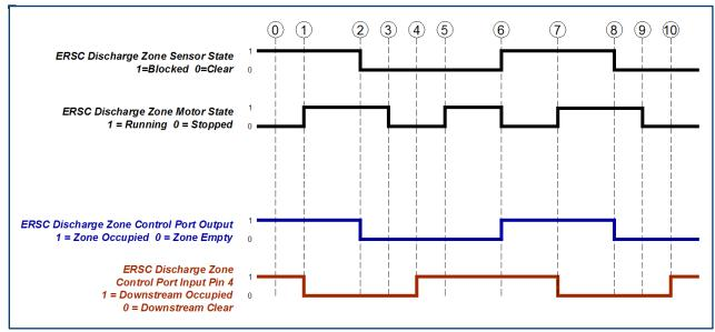
FIGURE 29 - TYPICAL DOWNSTREAM INTERLOCK TIMING EXAMPLE
