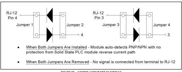
FIGURE 38 – JUMPER LAYOUT FOR SE MODULE
