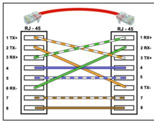
FIGURE 10 - ETHERNET CROSSOVER CABLE DIAGRAM FOR REVISION 1
