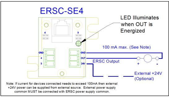
FIGURE 37 - TYPICAL ERSC OUTPUT CONNECTION EXAMPLE
