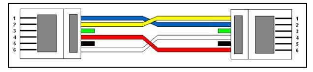
FIGURE 22 - TYPICAL MODULE TO MODULE HARDWARE CONNECTION
