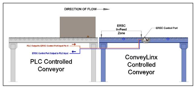
FIGURE 26 - TYPICAL UPSTREAM CONVEYOR INTERLOCK EXAMPLE
