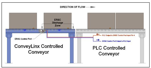
FIGURE 28 - TYPICAL DOWNSTREAM CONVEYOR INTERLOCK EXAMPLE
