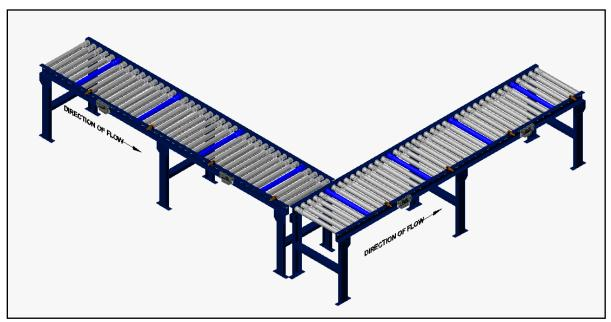
FIGURE 44 - TYPICAL T-ZONE CONFIGURATION
