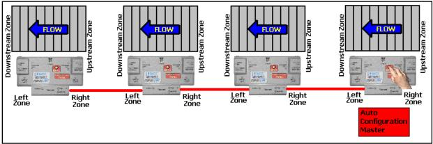
FIGURE 14 - SIMPLE AUTO CONFIGURATION EXAMPLE IN OPPOSITE DIRECTION
