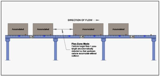
FIGURE 17 - TYPICAL FLEX ZONE MODE EXAMPLE
